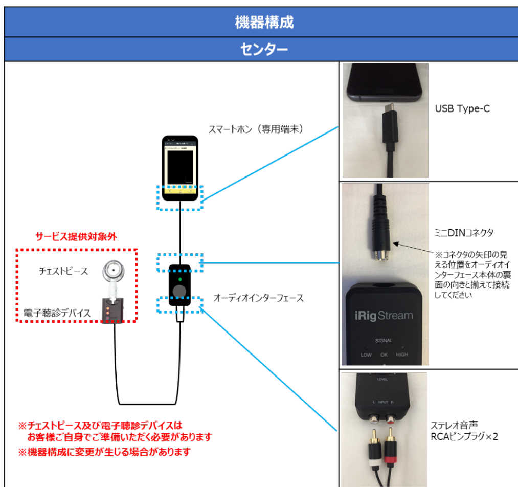
図 16 リモート拠点 機器接続詳細
