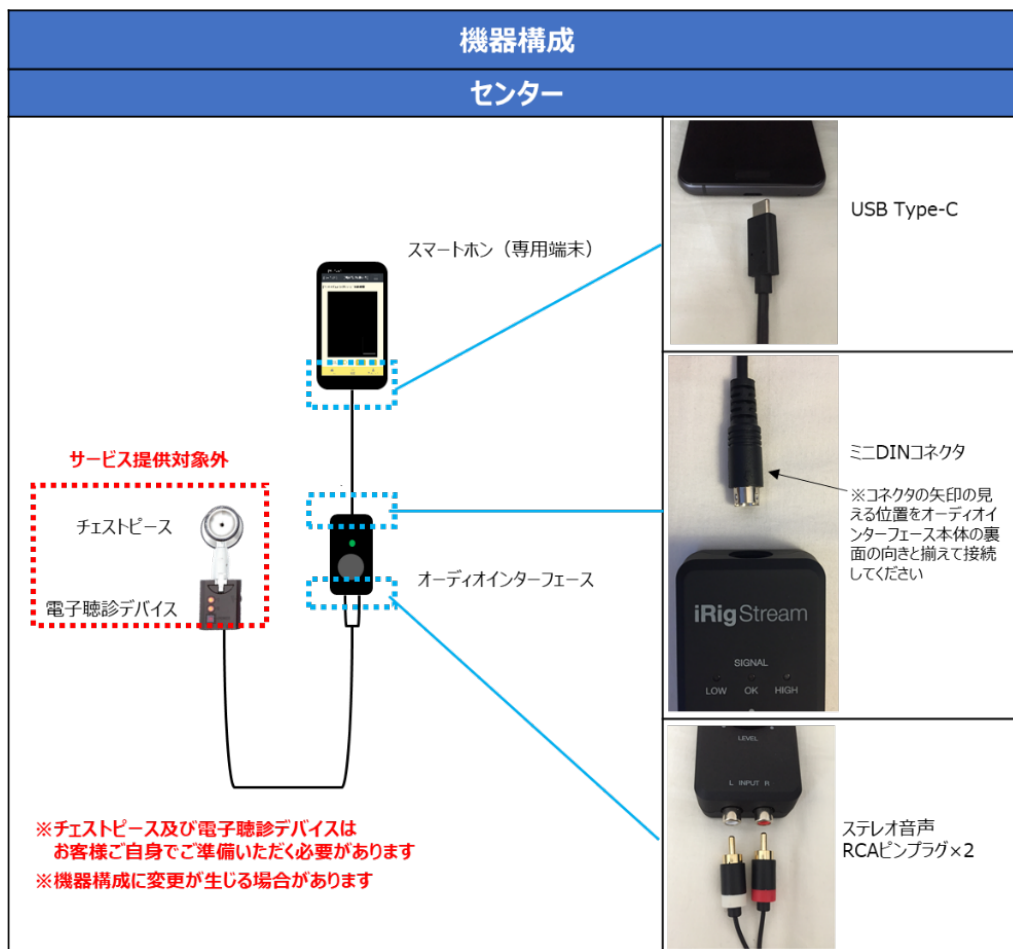
図 16 リモート拠点 機器接続詳細
